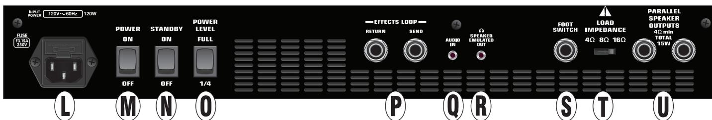
**L. CONNETTORE DI ALIMENTAZIONE:** Collegare qui il cavo di alimentazione incluso con la tensione e la frequenza indicate sopra il connettore. Il portafusibili incorporato nel connettore include un fusibile di ricambio. Sostituire i fusibili solo con fusibili con i valori nominali di corrente e tensione indicati accanto al connettore.
