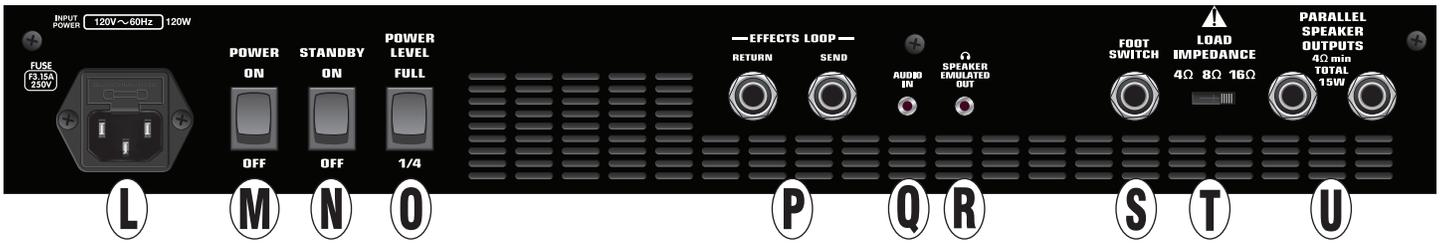
**L. POWER INPUT (電源輸入):** 根據放大器後面板上列出的電壓和頻率額定值, 在此處將隨附的電源線連接到放大器。電源輸入的一體式保險絲座裝有備用保險絲。只能使用與放大器背面印製的電流和電壓額定值相同的保險絲進行更換。
