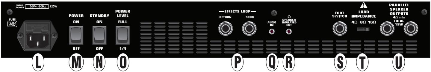
**L. NETZANSCHLUSS:** Schließen Sie hier das mitgelieferte Netzkabel mit der über dem Anschluss angegebenen Spannung und Frequenz an. Der im Stecker integrierte Sicherungshalter enthält eine Ersatzsicherung. Ersetzen Sie Sicherungen nur durch Sicherungen mit den neben dem Anschluss aufgeführten Strom- und Spannungswerten.
