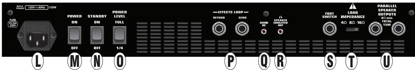
**L. 电源输入接口 (POWER INPUT):** 根据放大器后面板上列出的额定电压和频率, 将随附的电源线插入到此接口。电源输入接口的一体式保险丝架上有一个备用保险丝。如烧断了保险丝, 请仅用具有与印在放大器背面的电流和电压额定值相同规格的保险丝来替换。
